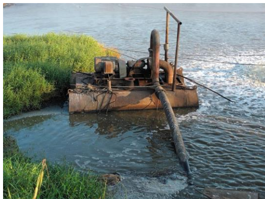
รูปที่ 64 เครื่องสูบน้ำจากคลองระบายน้ำเสีย
